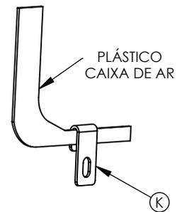
OBS: Na parte dianteira, tem uma proteção por cima do plástico da caixa de ar, é preciso afrouxar o parafuso inferior desta proteção, encaixar o suporte "K" e apertar o parafuso novamente.
