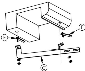
1 - Retirar as borrachas protetoras da caixa de ar e do chassi do veículo e encaixar os pontaletes "F", em seguida fixar os suportes "C" com auxílio das arruelas e porcas M8 que seguem nos pontaletes, mas sem dar o aperto final ainda.
