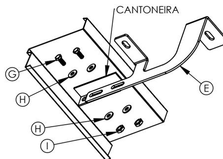
5 - Verificar se o estribo está alinhado com a lateral do veículo de forma que preencha todos os espaços e efetuar o aperto total de todos os parafusos.
